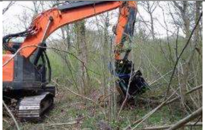
Traitement du sous étage (uniquement réalisé dans le système à 2 engins)
