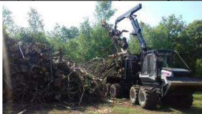
Déchargement du porteur sur la place de dépôt
