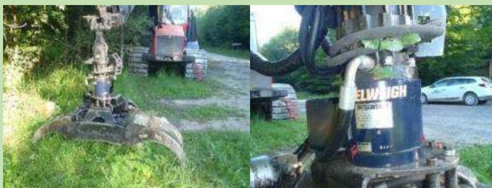
Le peson en vue rapprochée, entre la grue et le grappin
