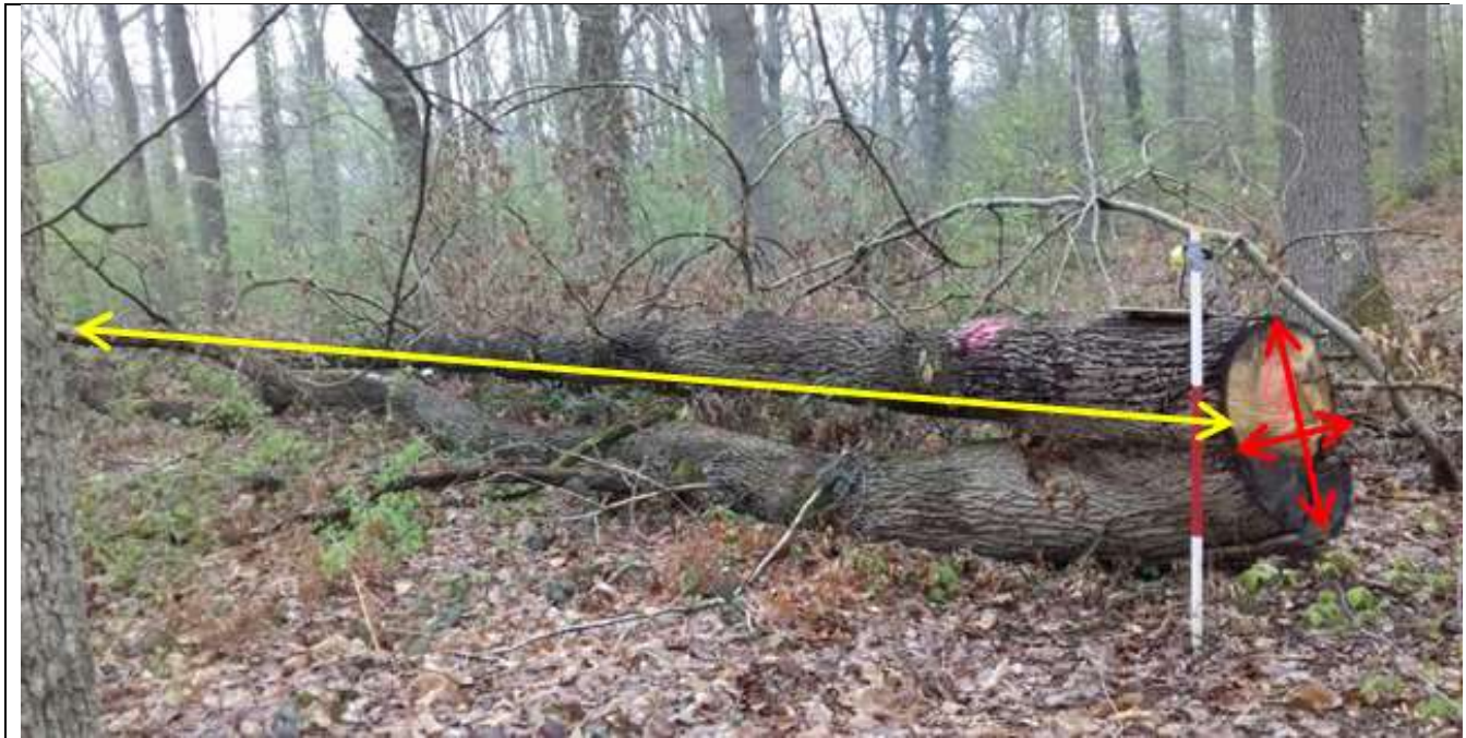
Prise de mesure des caractéristiques des houppiers
