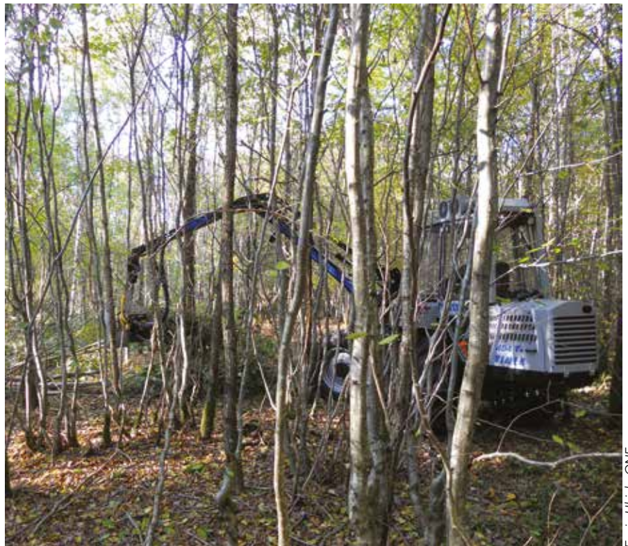
Portée de la grue : petite machine de bûcheronnage
