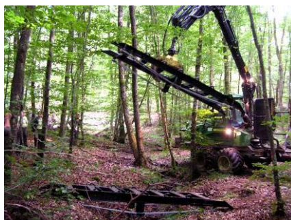
Les rampes métalliques utilisables pour les porteurs et machines de bûcheronnage (source FCBA)
