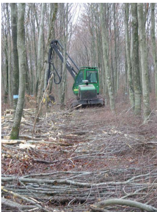
Abatteuse circulant dans un cloisonnement sur un tapis de rémanents (source FCBA)
