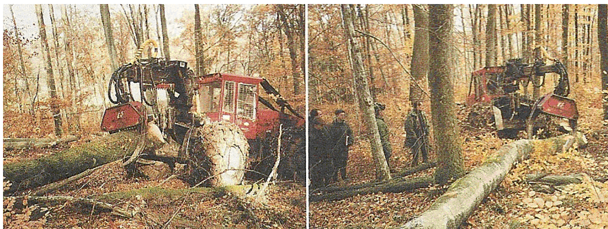
Opérations de débardage à l'aide d'un débusqueur à pince
