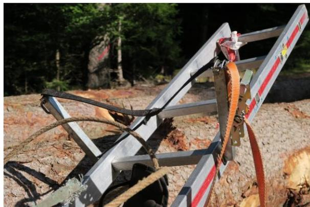
Photo 3 : Echelle avec système d'arrimage
